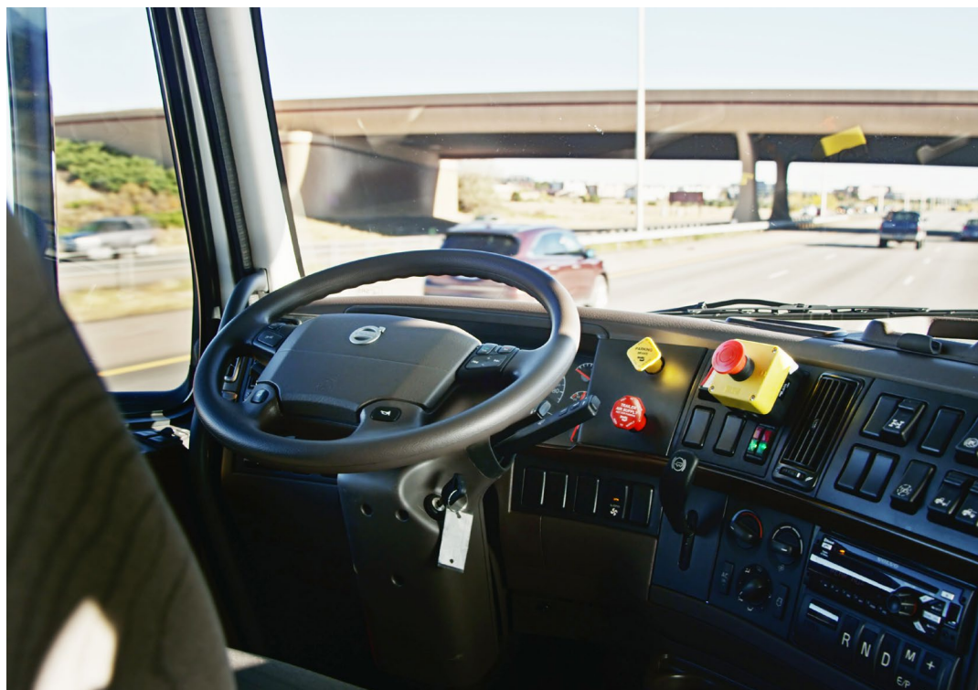
Sopra, la postazione di guida del camion Otto con i comandi per disattivare la modalità driverless in caso di necessità. In basso, l'addetto al trasporto impegnato durante il viaggio nelle operazioni di controllo del carico e del sistema.
