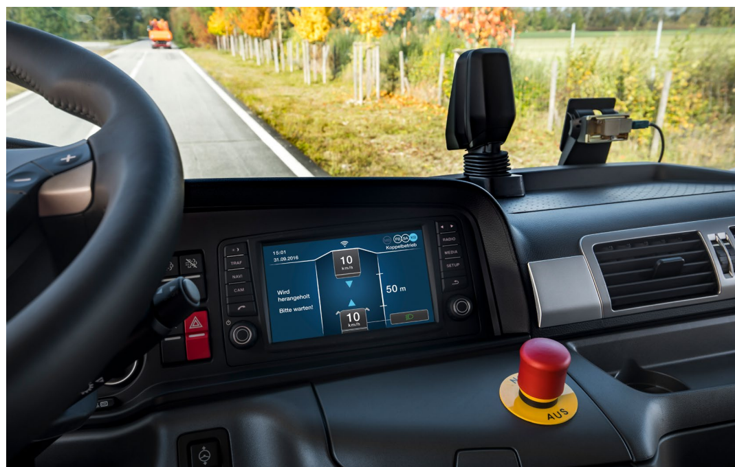
Il display mostra lo stato attuale del sistema. Un sensore ottico controlla tutte le attività dal "punto di vista del conducente", senza rendere necessaria la presenza fisica di un addetto.
